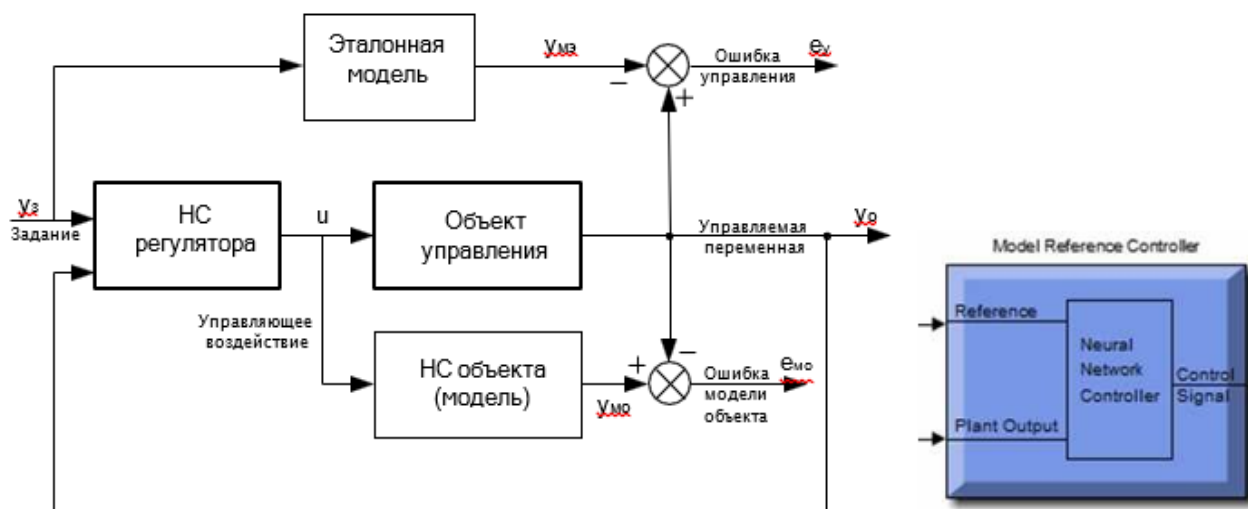
3.6 сурет - Эталонды моделмен НС реттегішіне негізделген басқару жүйесінің құрылымы және Simulink кітапханасындағы реттегіш блогының белгіленуі
